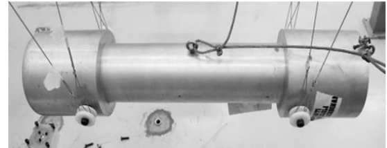
Figura 2. Configurazione delle prove sperimentali di impatto con pendolo. Figura 3. Impattatore usato nelle prove sperimentali.
